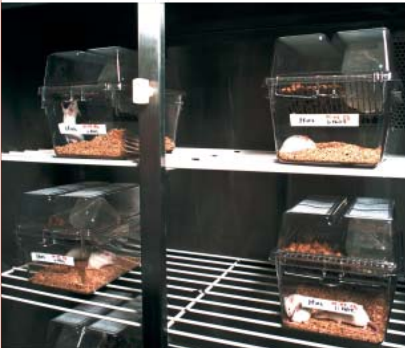
Quatre cages de souris (utilisées en expérimentation sur la fièvre Q) avec couvercle filtrant dans une armoire ventilée.
